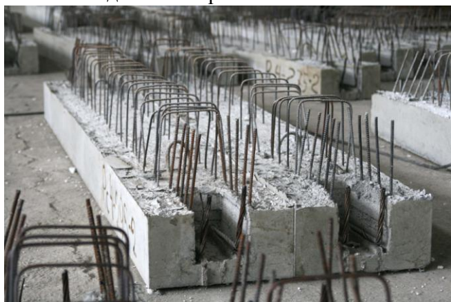
Готовая продукция – преднапряженные ригеля
