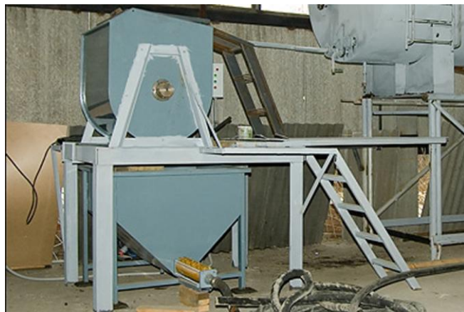
Смеситель с героторным насосом
