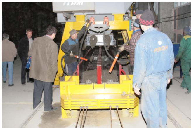
Первая заливка преднапряженных ригелей
